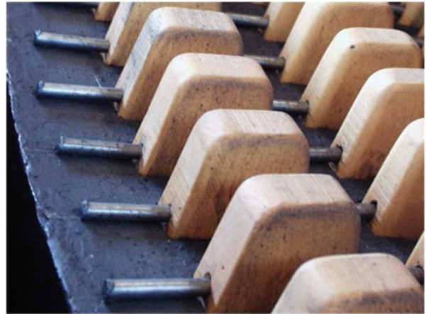
Holzkamrad am Generatorantrieb
